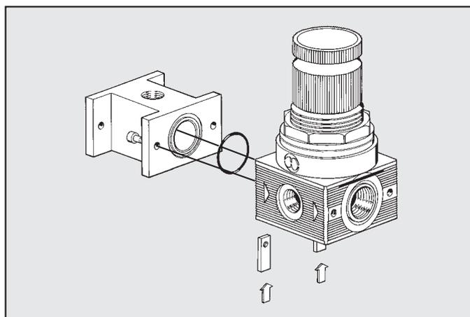
Montage de la prise d'air en entrée: utiliser seulement 2 vis un joint O-ring fournis dans le kit PA .
