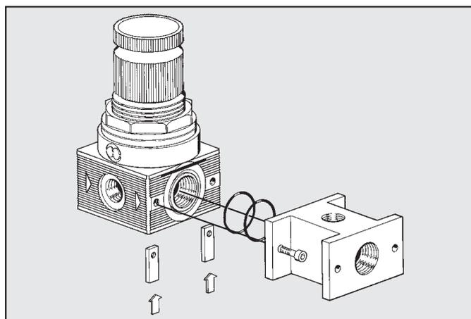
Montage de la prise d'air en sortie: utiliser seulement 2 vis un joint O-ring fourni dans le kit PA. L'étanchéité est assurée par le contact des deux joints O-ring.
